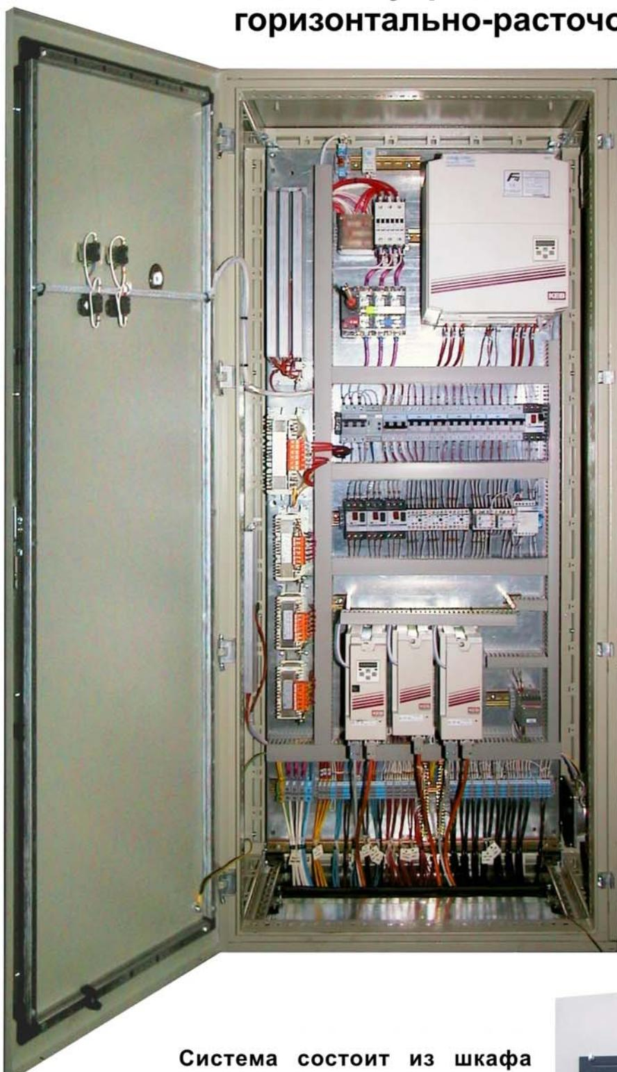
Система состоит из шкафа управления электроприводами и электроавтоматики, а также пульта оператора с ЧПУ NC210. Для управления двигателем главного привода используется преобразователь частоты фирмы KEB типа F4C. Для управления приводами подачи используются привода типа F5 MULTI.
